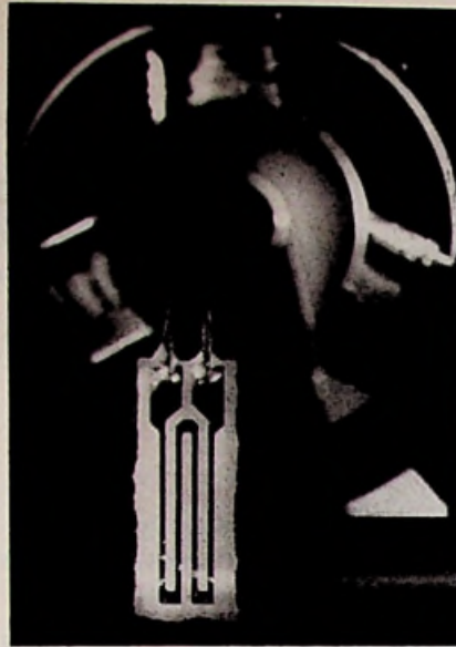
Fig. 7: Minuscule Fluxistoren vervangen hier de anders in een gelijkstroommotor noodzakelijke kollektor.
