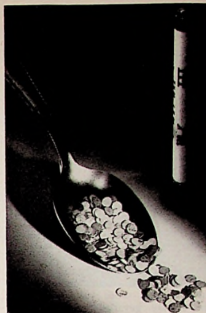
Trijke seleenplaatjes - bijna een theelepeltje vol - vormen op elkaar geperst de inhoud van het keramische buisje van een moderne 18 kV TV-hoogspanningsgelijkrichter Foto SEL
